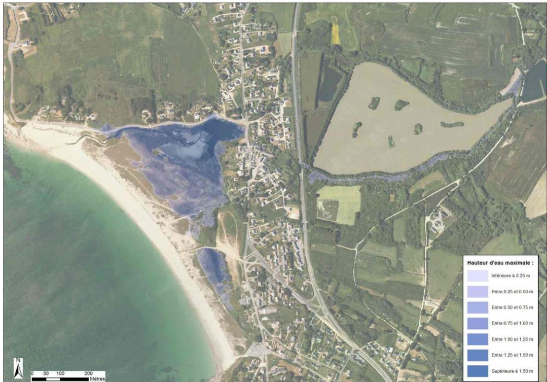
Figure 7-26 : Kerpont – Cartographie de la hauteur de submersion modélisée pour un évènement centennial
