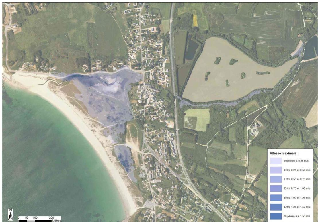
Figure 7-29 : Kerpont – Cartographie de la vitesse d'écoulement modélisée pour un évènement centennal à l'horizon 2100
