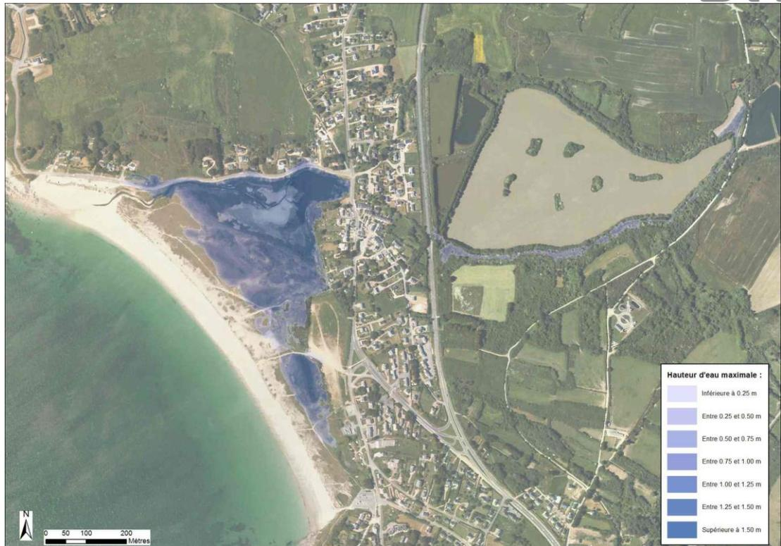
Figure 7-28 : Kerpont – Cartographie de la hauteur de submersion modélisée pour un évènement centennal à l'horizon 2100
