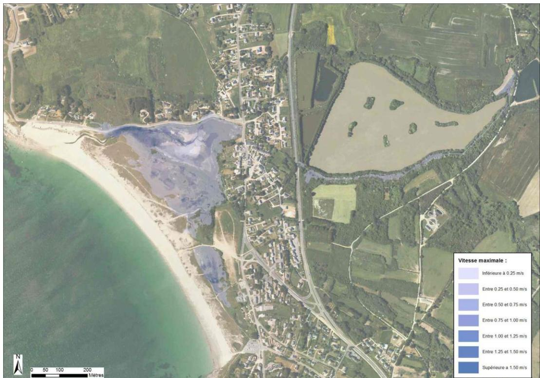
Figure 7-27 : Kerpont – Cartographie de la vitesse d'écoulement modélisée pour un évènement centennial
