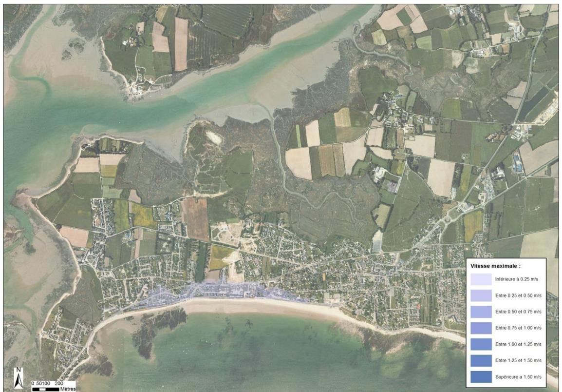
Figure 7-105 : Grande Plage de Damgan – Cartographie de la vitesse d'écoulement modélisée pour un évènement centennal
