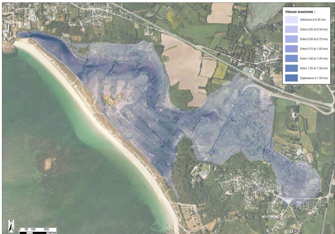
Figure 7-24 : Plage de Kervert – Cartographie de la vitesse d'écoulement modélisée pour un évènement centennal à l'horizon 2100
