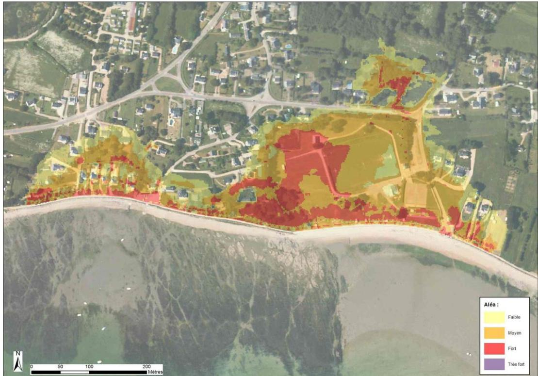
Figure 8-11 : Kermor – Cartographie de l'aléa submersion modélisée pour un évènement centennal
