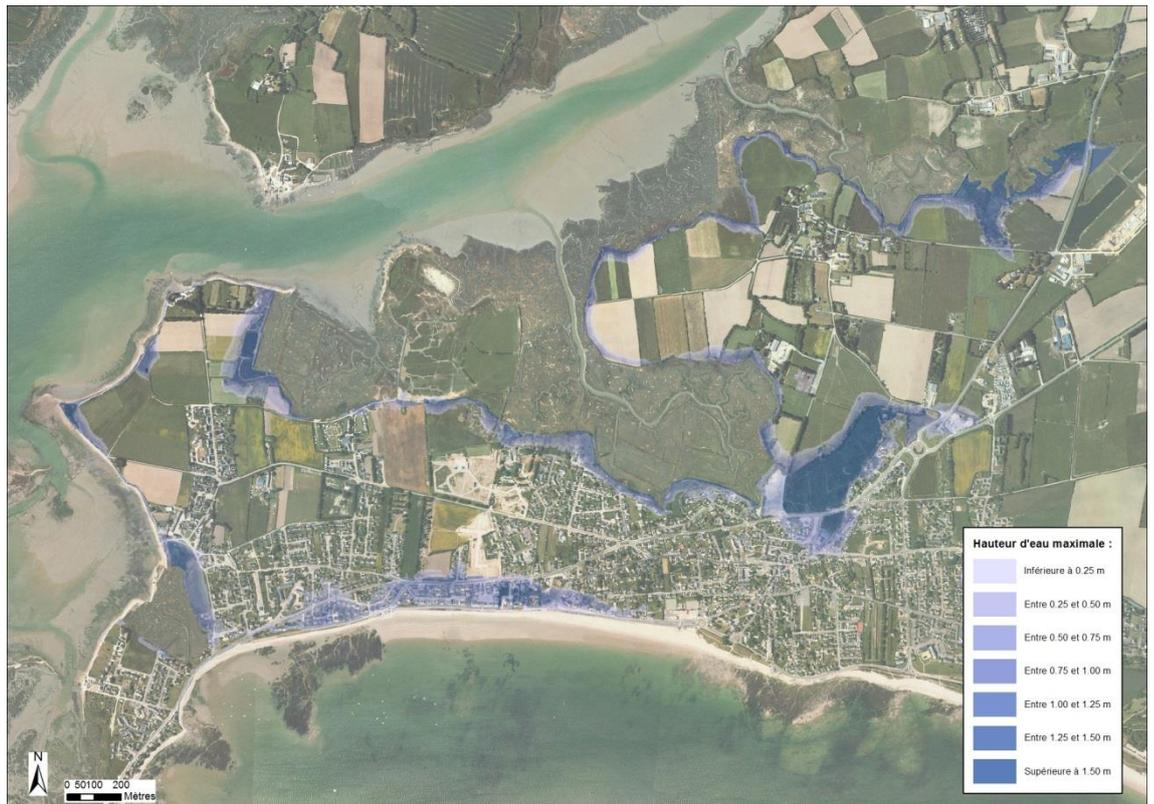
Figure 7-104 : Grande Plage de Damgan – Cartographie de la hauteur de submersion modélisée pour un évènement centennal
