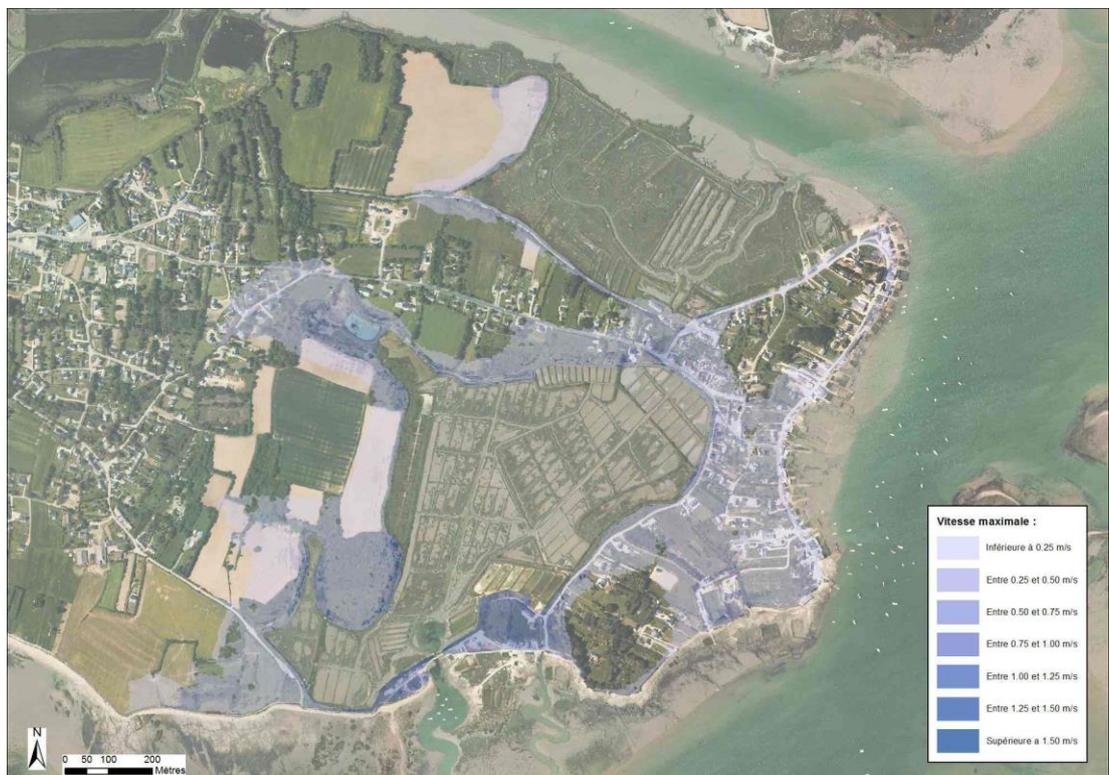
Figure 7-86 : Pen Cadenic – Cartographie de la vitesse d'écoulement modélisée pour un évènement centennal à l'horizon 2100
