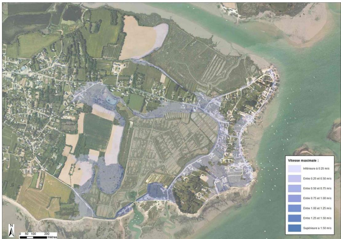
Figure 7-84 : Pen Cadenic – Cartographie de la vitesse d'écoulement modélisée pour un évènement centennal
