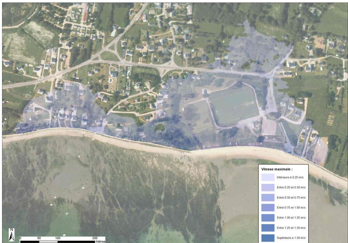
Figure 7-80 : Kermor – Cartographie de la vitesse d'écoulement modélisée pour un évènement centennal à l'horizon 2100
