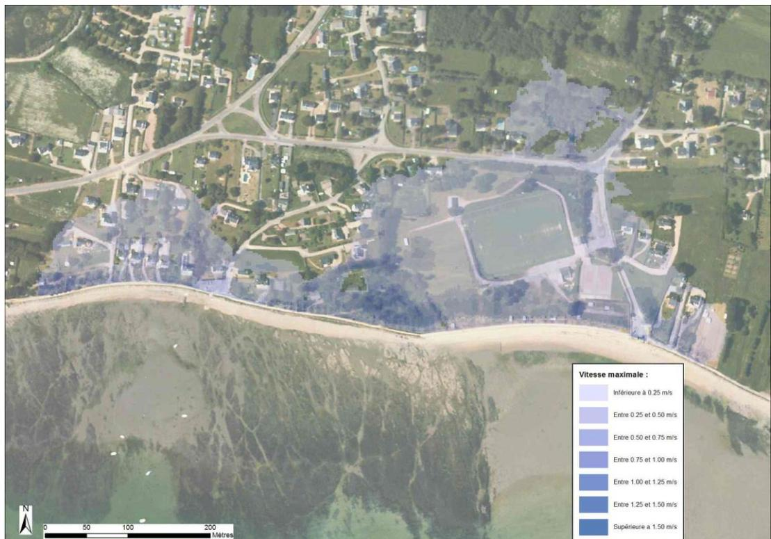
Figure 7-78 : Kermor – Cartographie de la vitesse d'écoulement modélisée pour un évènement centennial
