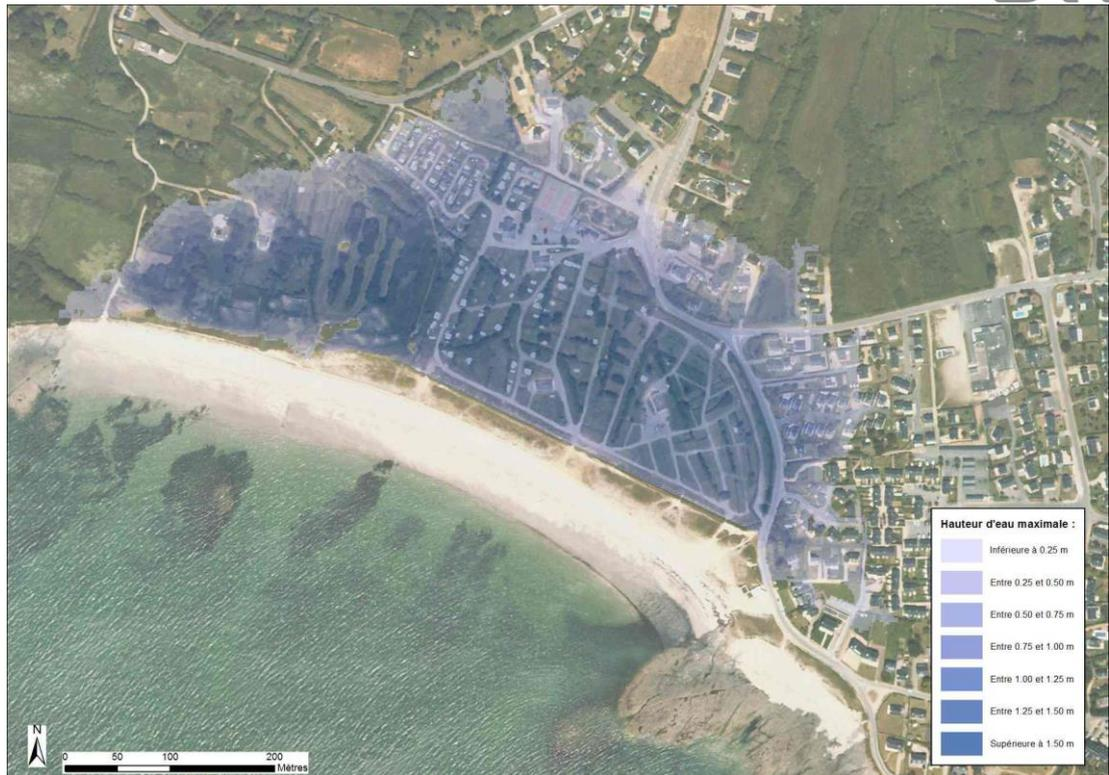
Figure 7-37 : Saint Jacques - Camping – Cartographie de la hauteur de submersion modélisée pour un évènement centennal à l'horizon 2100
