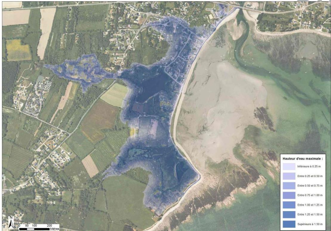
Figure 7-71 : Banastère – Cartographie de la hauteur de submersion modélisée pour un évènement centennal à l'horizon 2100
