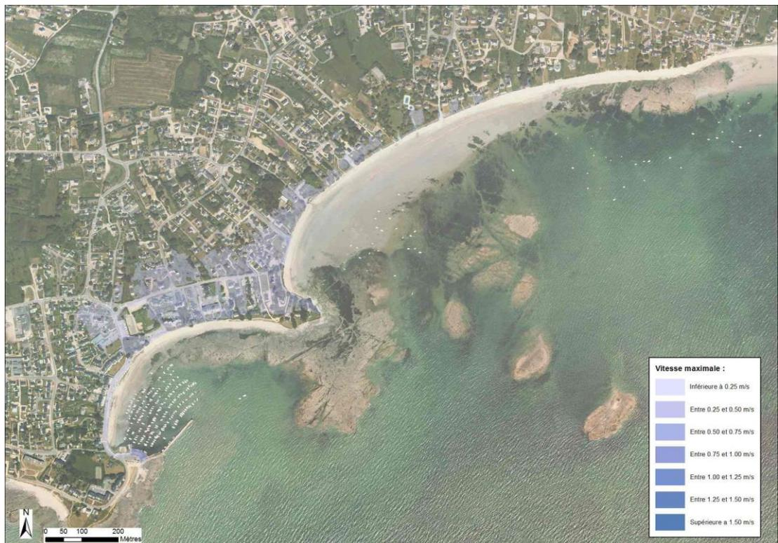
Figure 7-44 : Saint Jacques - Port – Cartographie de la vitesse d'écoulement modélisée pour un évènement centennal
