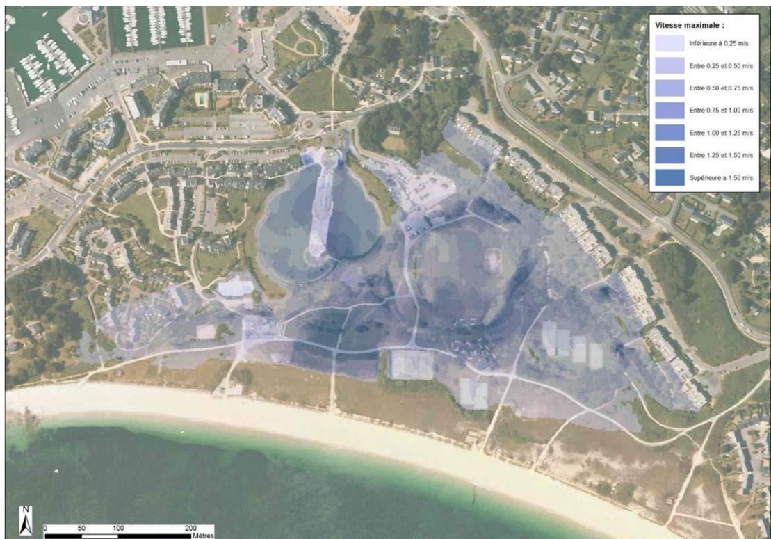
Figure 7-15 : Plage du Fogo – Cartographie de la vitesse d'écoulement modélisée pour un évènement centennal à l'horizon 2100
