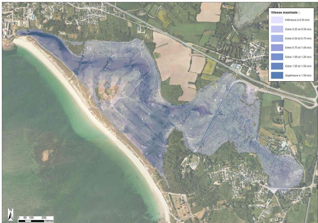
Figure 7-22 : Plage de Kervert – Cartographie de la vitesse d'écoulement modélisée pour un évènement centennial
