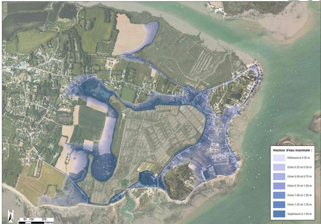
Figure 7-85 : Pen Cadenic – Cartographie de la hauteur de submersion modélisée pour un évènement centennal à l'horizon 2100
