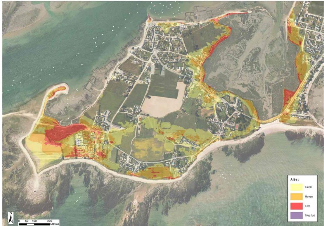
Figure 8-13 : Pénerf – Cartographie de l'aléa submersion modélisée pour un évènement centennal
