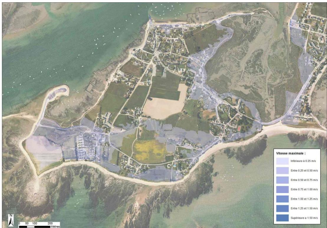
Figure 7-97 : Pénérf – Cartographie de la vitesse d'écoulement modélisée pour un évènement centennal
