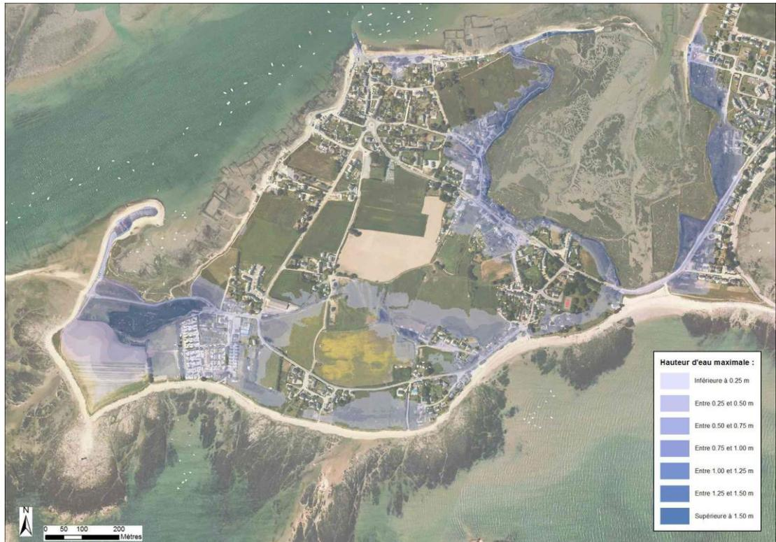
Figure 7-96 : Pénérf – Cartographie de la hauteur de submersion modélisée pour un évènement centennal
