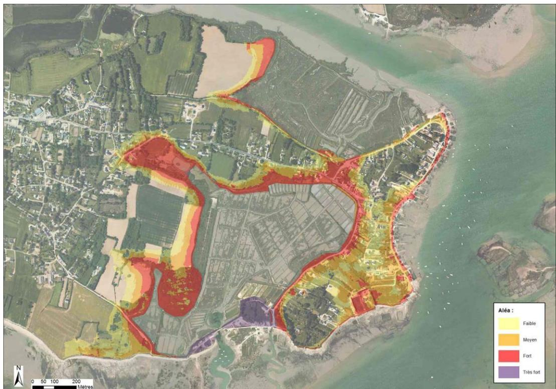
Figure 8-25 : Pen Cadenic – Cartographie de l'aléa submersion modélisée pour un évènement centennal à l'horizon 2100
