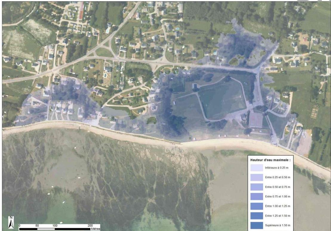
Figure 7-79 : Kermor – Cartographie de la hauteur de submersion modélisée pour un évènement centennal à l'horizon 2100
