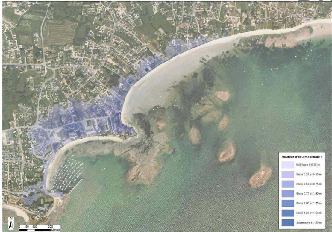
Figure 7-45 : Saint Jacques - Port – Cartographie de la hauteur de submersion modélisée pour un évènement centennal à l'horizon 2100
