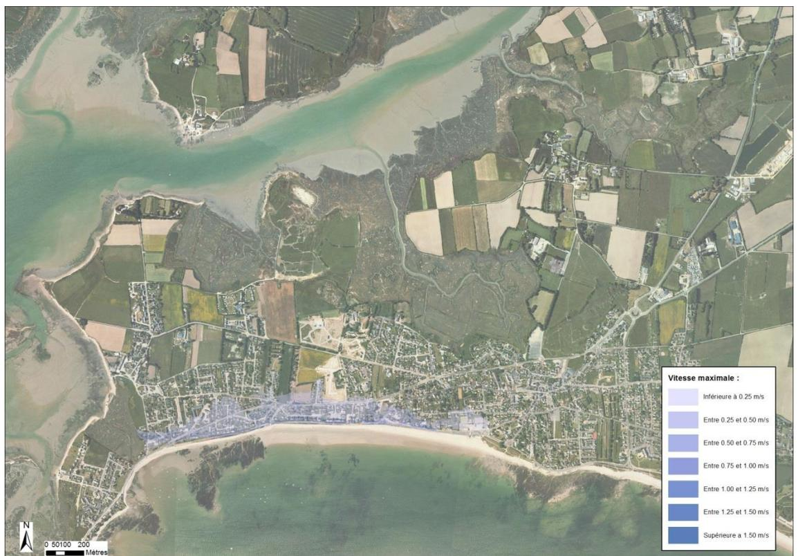
Figure 7-107 : Grande Plage de Damgan – Cartographie de la vitesse d'écoulement modélisée pour un événement centennal à l'horizon 2100
