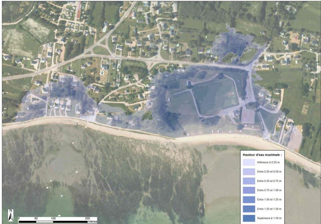
Figure 7-77 : Kermor – Cartographie de la hauteur de submersion modélisée pour un évènement centennial
