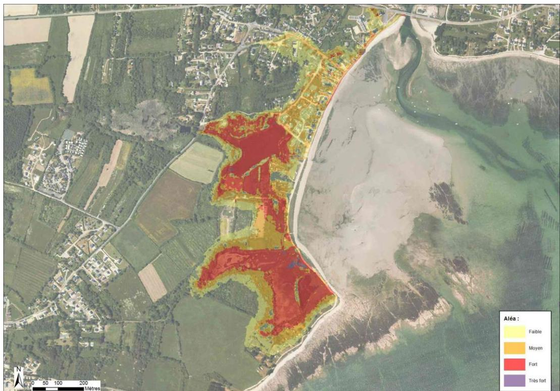
Figure 8-10 : Banastère – Cartographie de l'aléa submersion modélisée pour un évènement centennal
