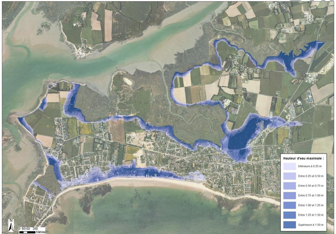
Figure 7-106 : Grande Plage de Damgan – Cartographie de la hauteur de submersion modélisée pour un événement centennal à l'horizon 2100
