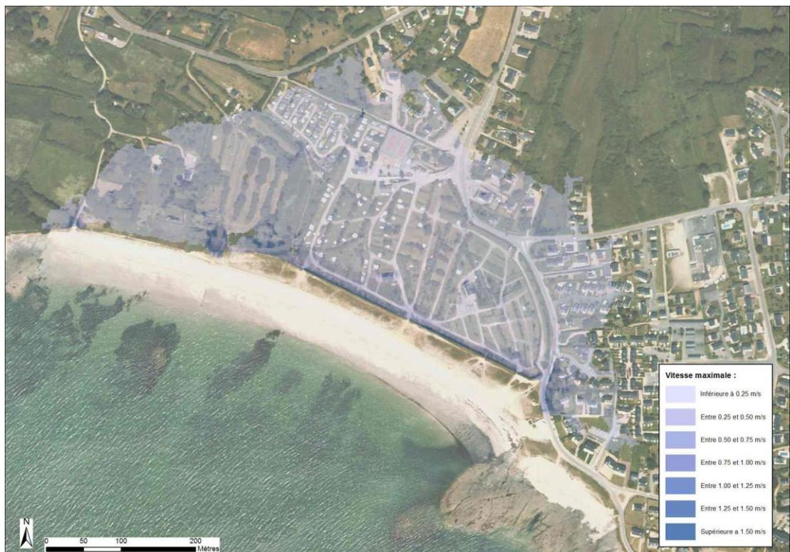
Figure 7-38 : Saint Jacques - Camping – Cartographie de la vitesse d'écoulement modélisée pour un évènement centennal à l'horizon 2100
