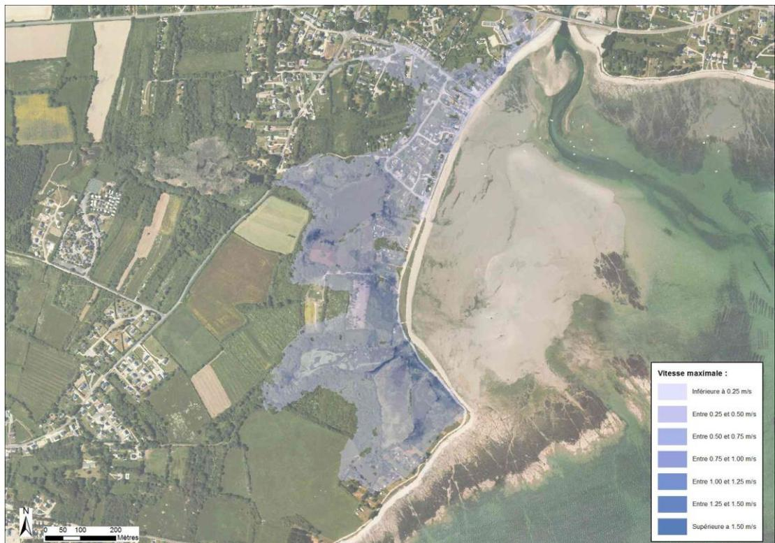
Figure 7-70 : Banastère – Cartographie de la vitesse d'écoulement modélisée pour un évènement centennal
