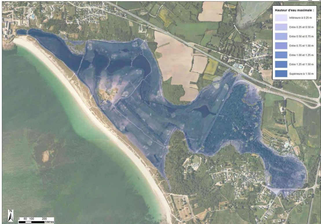
Figure 7-23 : Plage de Kervert– Cartographie de la hauteur de submersion modélisée pour un évènement centennal à l'horizon 2100
