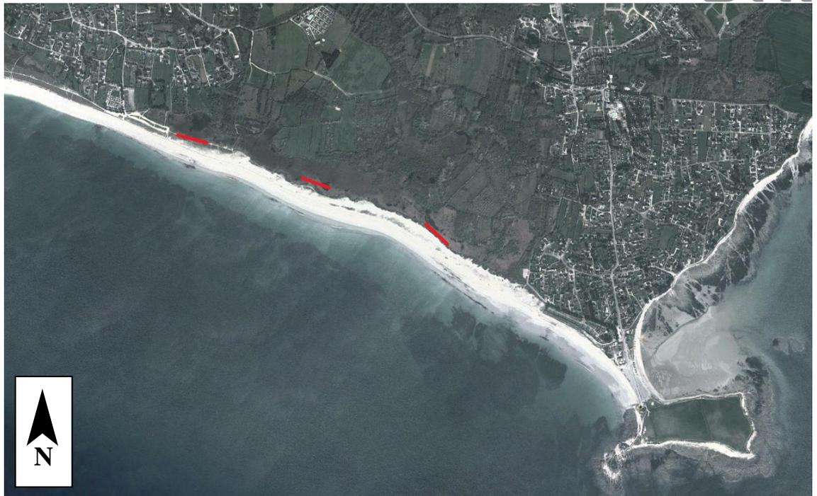
Figure 7-56 : Position des brèches simulées sur le cordon dunaire de la plage de Penvins
