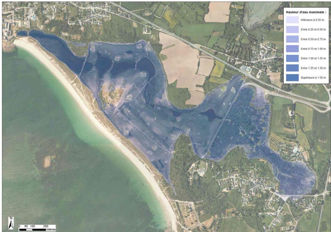
Figure 7-21 : Plage de Kervert – Cartographie de la hauteur de submersion modélisée pour un évènement centennial
