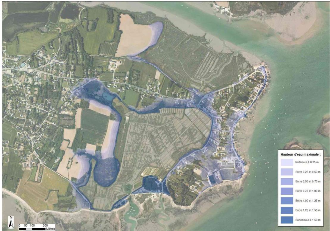
Figure 7-83 : Pen Cadenic – Cartographie de la hauteur de submersion modélisée pour un évènement centennal
