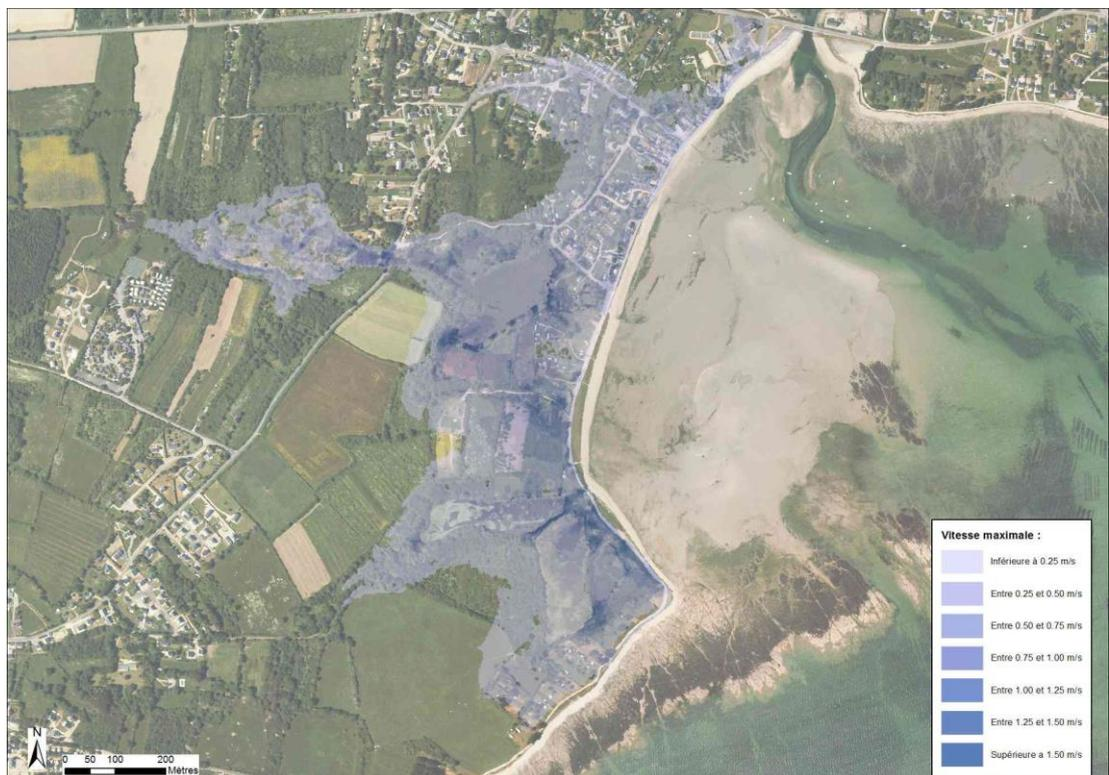
Figure 7-72 : Banastère – Cartographie de la vitesse d'écoulement modélisée pour un évènement centennal à l'horizon 2100
