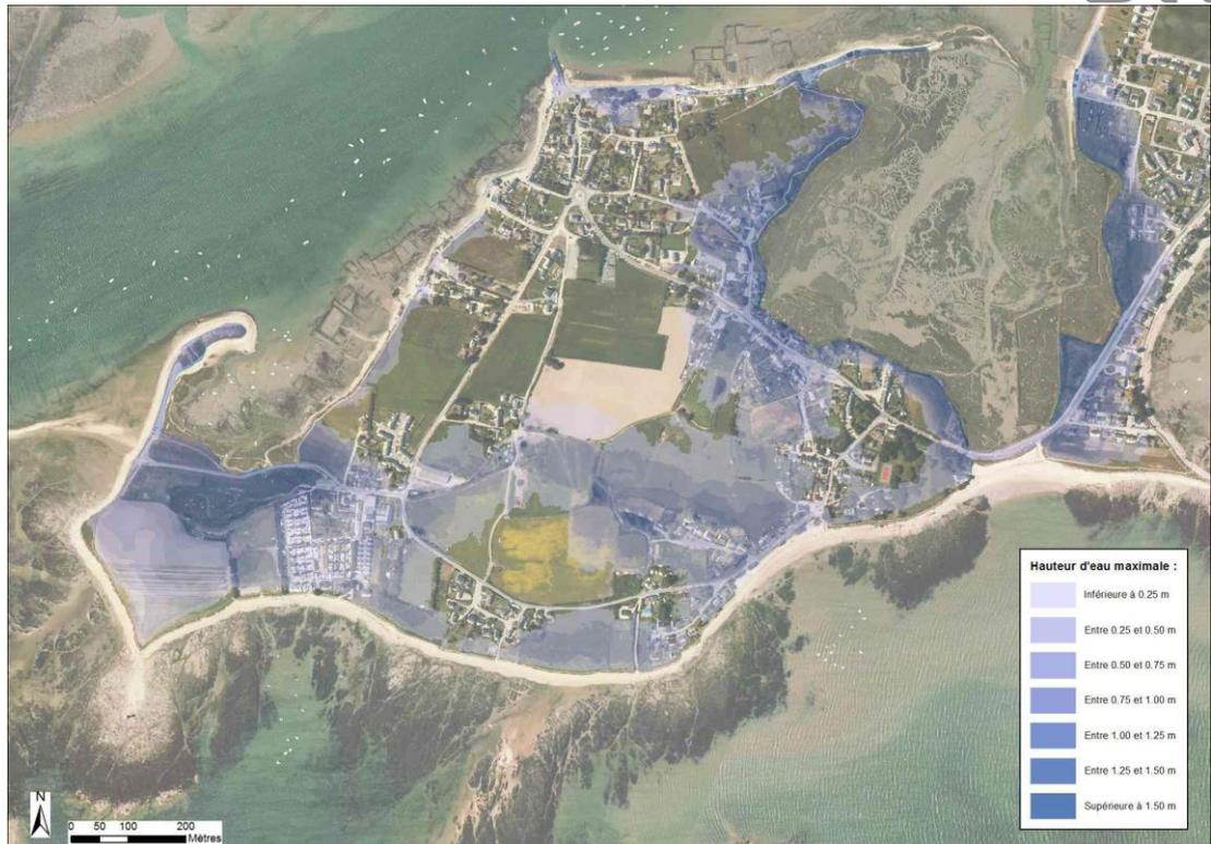
Figure 7-98 : Pénérf – Cartographie de la hauteur de submersion modélisée pour un évènement centennal à l'horizon 2100
