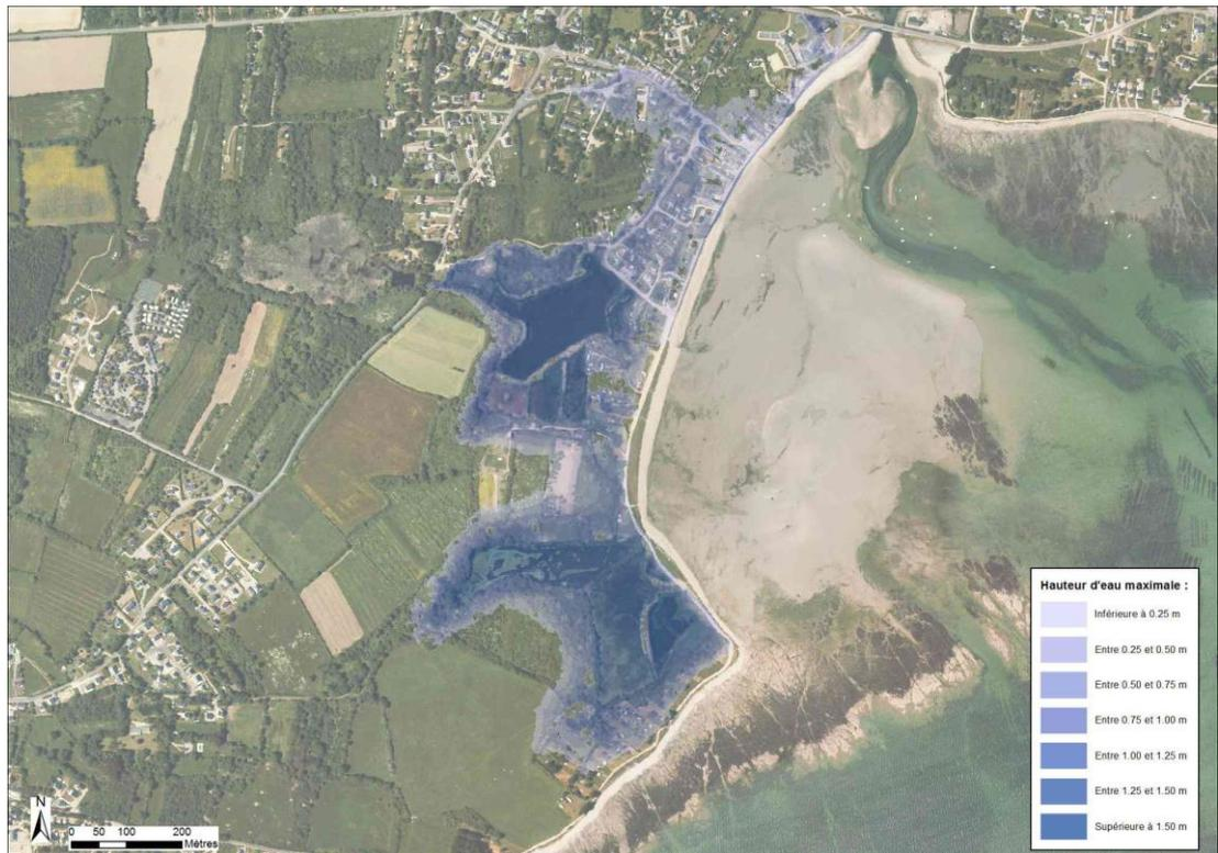
Figure 7-69 : Banastère – Cartographie de la hauteur de submersion modélisée pour un évènement centennal
