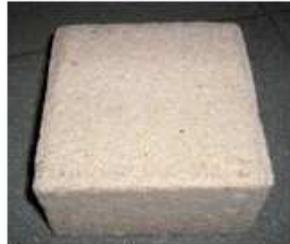
Pavés en béton poreux
