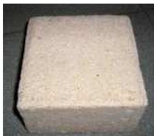
Pavés en béton poreux
